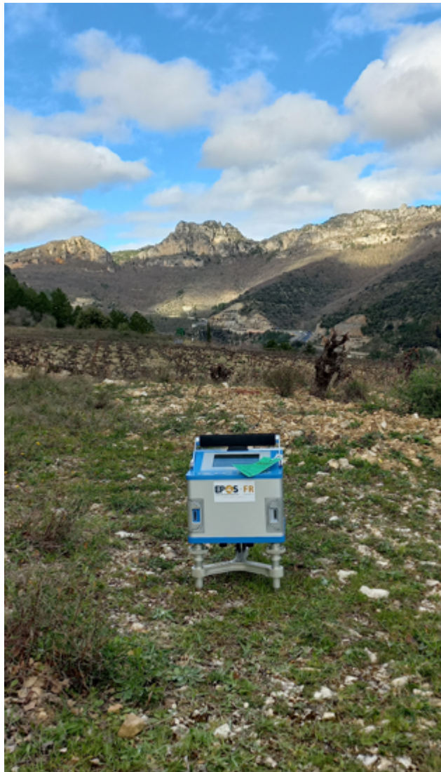
1 - Gravimètre relatif du Parc PGravi durant l'une des campagnes de mesure sur le site de Pégairolles de l'Escalette. ©Rodolphe Cattin
